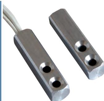
Viene montato con viti sul serramento, un'altra possibile applicazione è il montaggio della parte magnete sull'avvolgibile (che deve essere in materiale non ferromagnetico) in modo da avere una protezione contro il sollevamento dello stesso. La parte reed contiene una ampolla reed incapsulata ermeticamente con resina poliuretanica insieme ad un loop di tamper per ridurre le possibilità di effrazione. La connessione è a 4 fili (2 fili contatto NC con magnete vicino e 2 fili per tamper).
