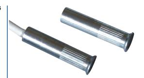
di intervento ne permette l'installazione anche su infissi con elevate tolleranze o giochi. Viene montato a pressione in un foro di 8 mm di diametro. La parte reed contiene una ampolla reed incapsulata ermeticamente con resina poliuretanica insieme ad un loop di tamper per ridurre le possibilità di effrazione. Disponibile con cavo di lunghezza 30cm e 2m. La connessione è a 4 fili.
