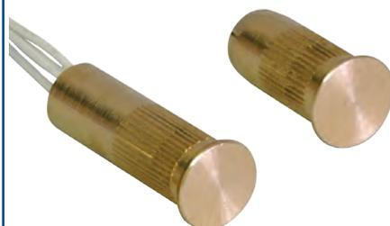
Viene montato a pressione in un foro di 8 mm di diametro. La parte reed contiene una ampolla reed incapsulata ermeticamente con resina poliuretanica insieme ad un loop di tamper per ridurre le possibilità di effrazione. Il modello 414 CTF-N è dotato di magnete piatto tipo 300-MA. La connessione è a 4 fili (2 fili contatto NC con magnete vicino e 2 fili per tamper).
