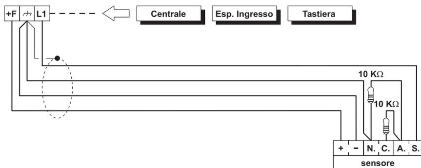
Figura 15 Collegamento di un sensore ad una Zona con Bilanciamento Doppio
