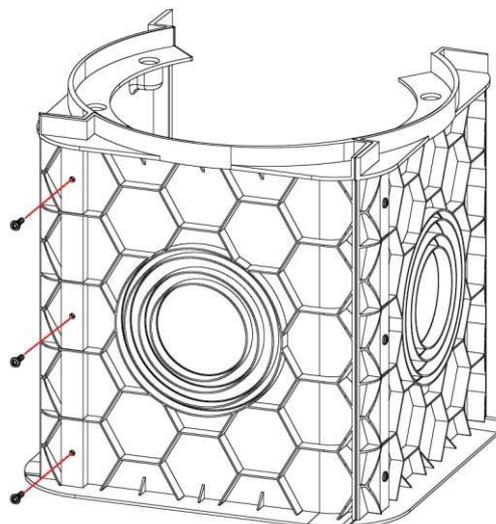
3. Allargare le due pareti opposte per permettere l'inserimento ad incastro del pozzetto
